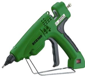
1/- Conecte la pistola a la red eléctrica y precaliéntela a la temperatura marcada en la bolsa del color de barra que vaya a utilizar. Para ello, sírvase de la ruleta de control de temperatura que hay en la parte inferior de la pistola.
